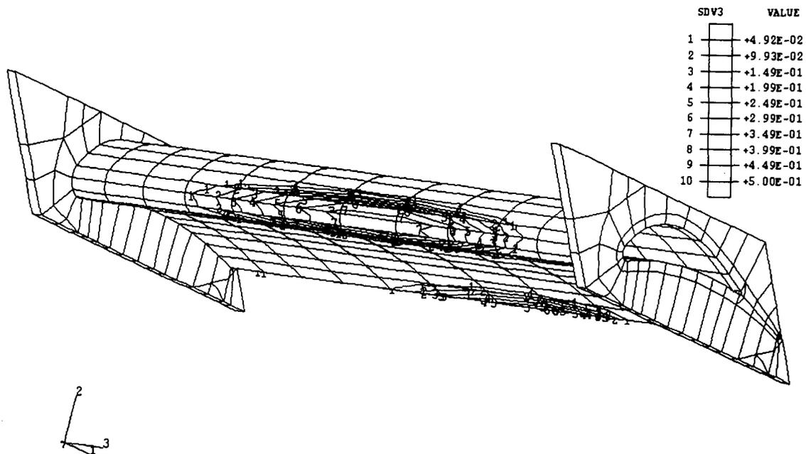
Fig. 4. Contour plot of creep damage parameter  $w_c$ .
