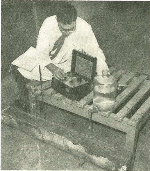
Meting van die oplossingspotensiaal van korroderende wapeningsstaal in beton.
