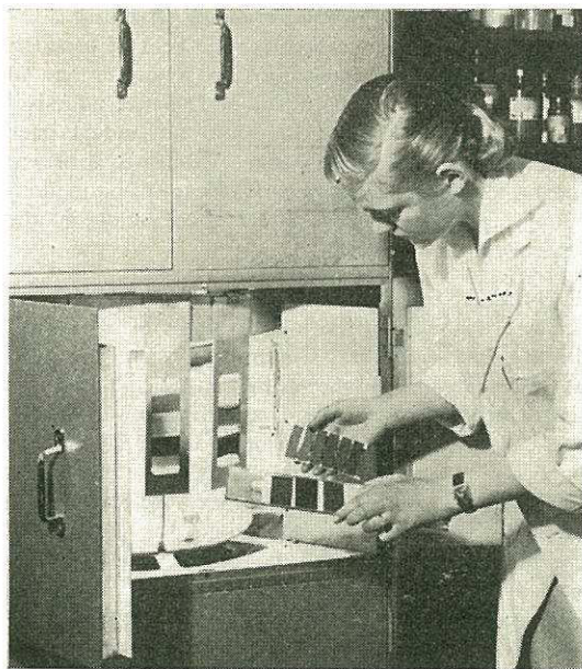
Monsters materiaal word in die Tekstiellaboratorium vir ligegtheid getoets.
