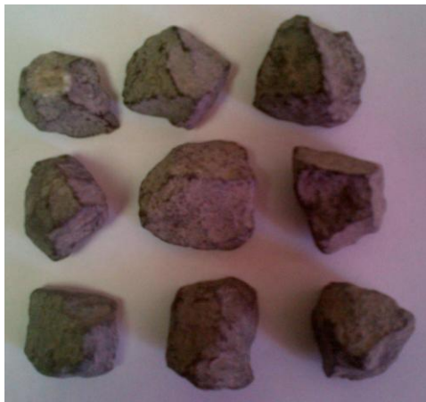
Actual tillite aggregates
